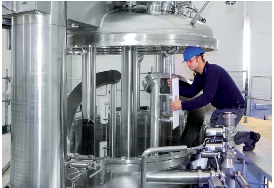
Abb. 4: Die Anlage SRC 10.000 von Ekato Systems zur Produktion von hochviskosen Emulsionen.
