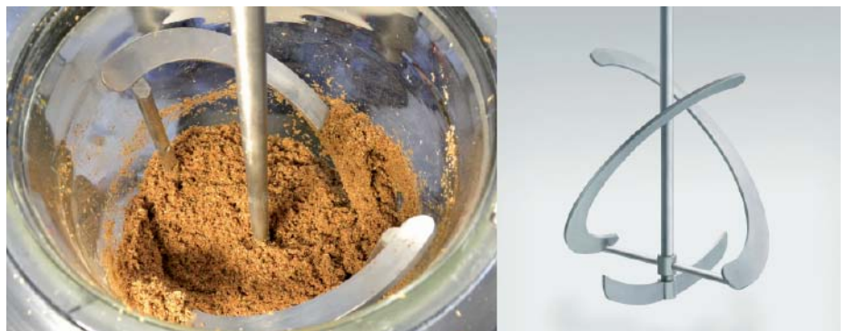
Abb. 2: Technikumsbehälter mit typischem wandgängigen Rührorgan (Ekato Paravisc).
