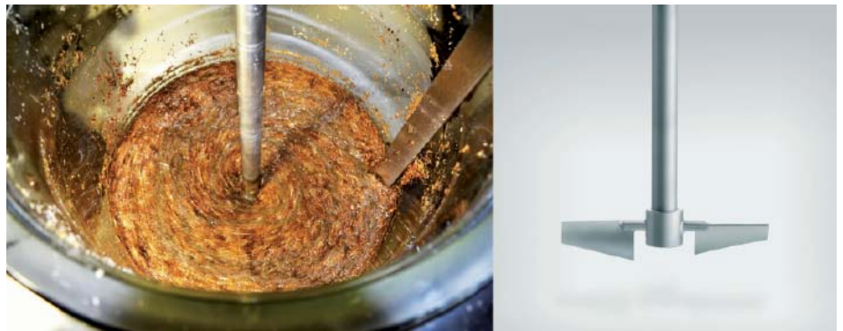
Abb. 1: Technikumsbehälter mit typischem Zentralrührorgan (Ekato Viscoprop).
